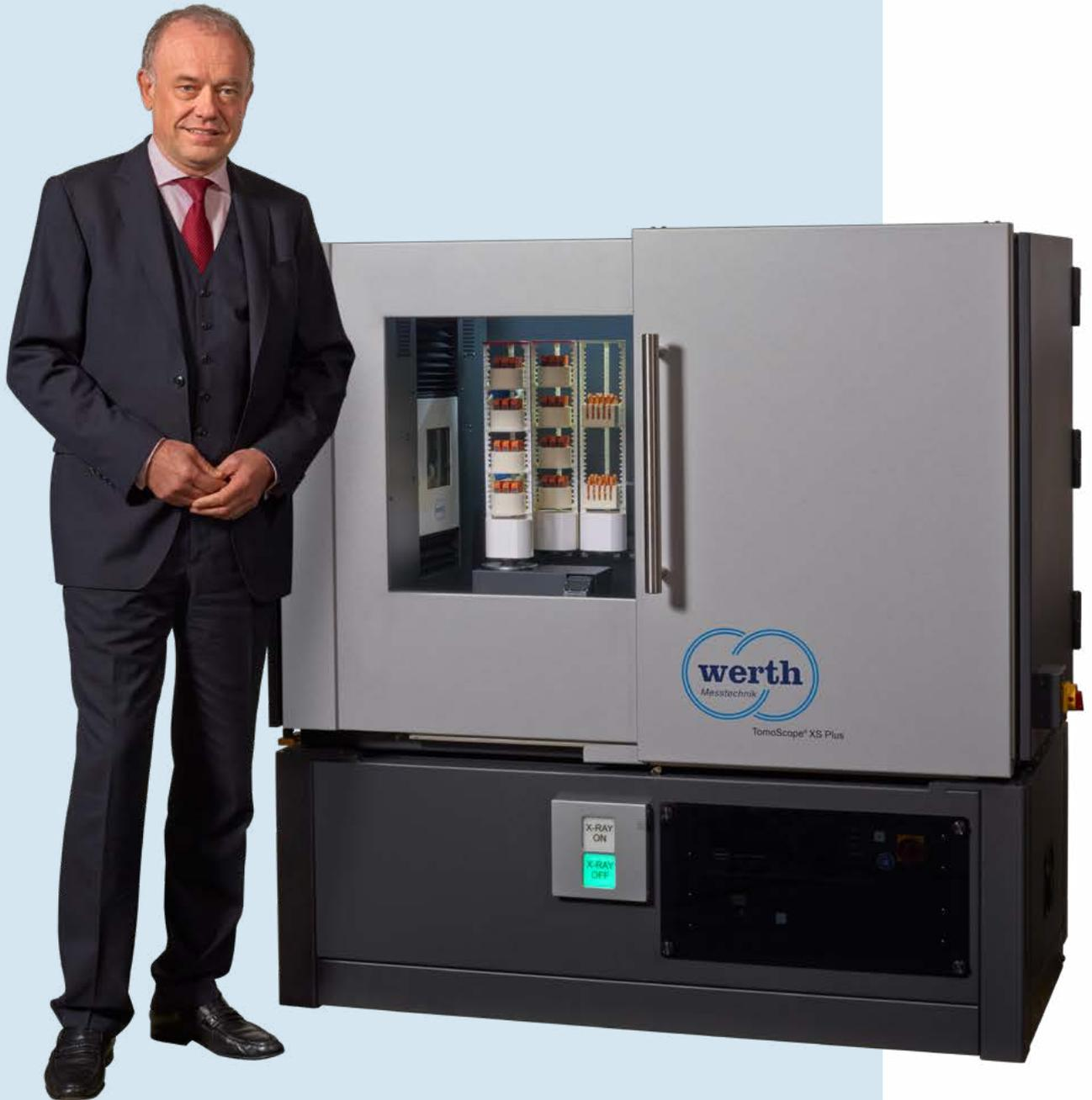
Die erfolgreichen TomoScope® XS Plus Geräte stehen jetzt auch mit 200 kV Beschleunigungsspannung und einem in die Umhausung integrierten Werkstückwechselsystem zur Verfügung
