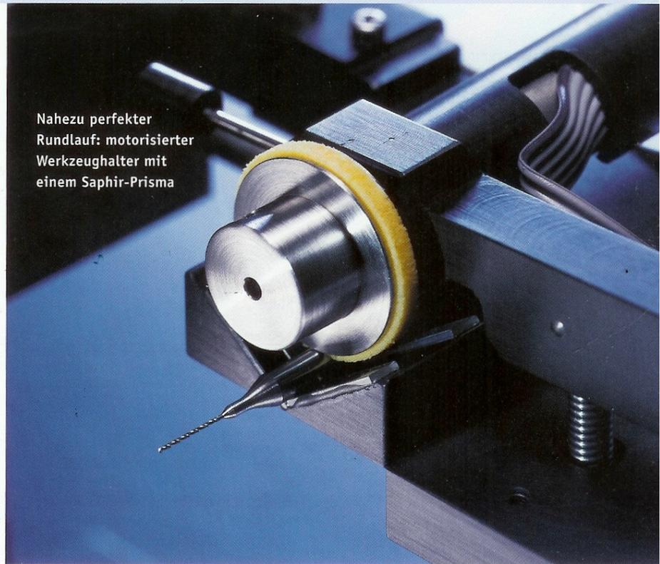
Nahezu perfekter Rundlauf: motorisierter Werkzeughalter mit einem Saphir-Prisma
