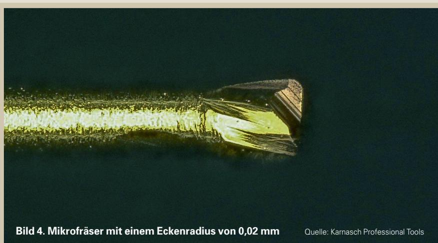
**Bild 4. Mikrofäser mit einem Eckenradius von 0,02 mm**
