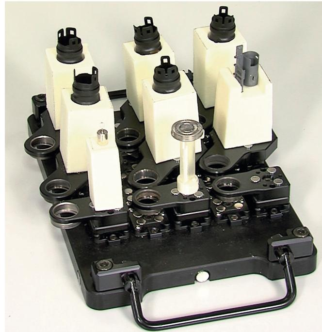
*Für prozessintegrierte Messungen und 3-Schicht-Betrieb kann ein automatisches Werkstückwechselsystem innerhalb der Strahlenschutzhaube des CT-Geräts integriert werden*
