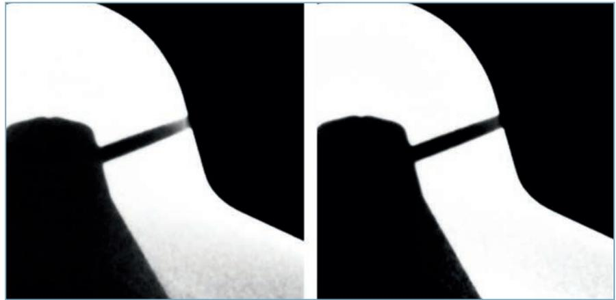
Bild 3. Volumenschnitt durch eine Einspritzdüse vor (links) und nach (rechts) der EAK (überhöhte Darstellung)
