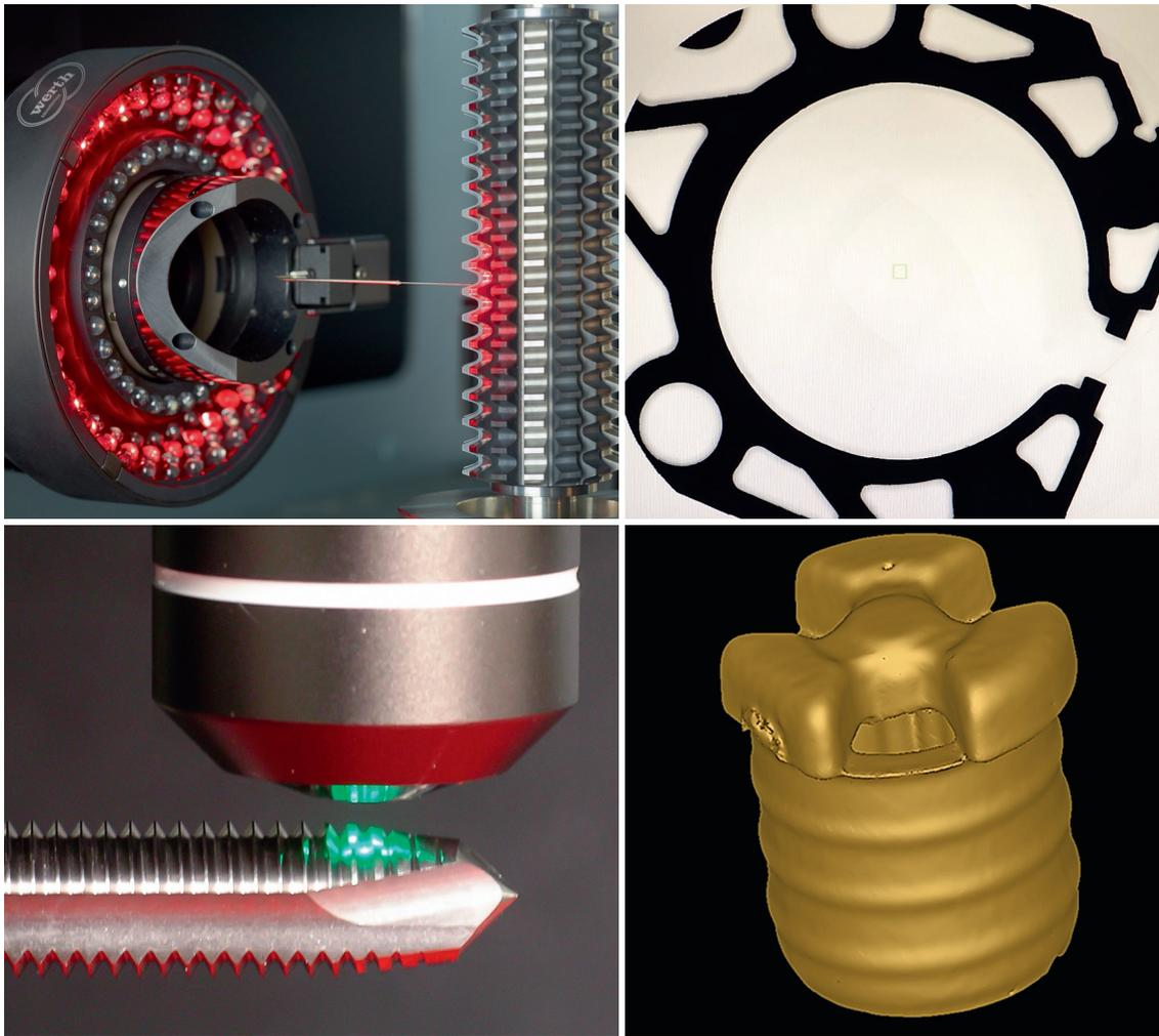
Die Bandbreite der Multisensorik: Messen von Punkten und Scannen von Konturen beziehungsweise Flächen mit Werth Fasertaster (oben links), Kantenmessung mit Bildverarbeitungssensor und Raster-scanning (oben rechts), Flächenmessung mit konfokalem Nano Focus Probe (unten links) und Volumenmessung mit Computertomografie-Sensor (unten rechts) Bilder: Werth
